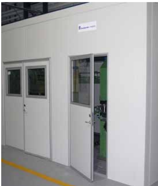
Inkapsling och ljuddämpning maskin Eden Europé s.r.o, Adamov, Tjeckien.
